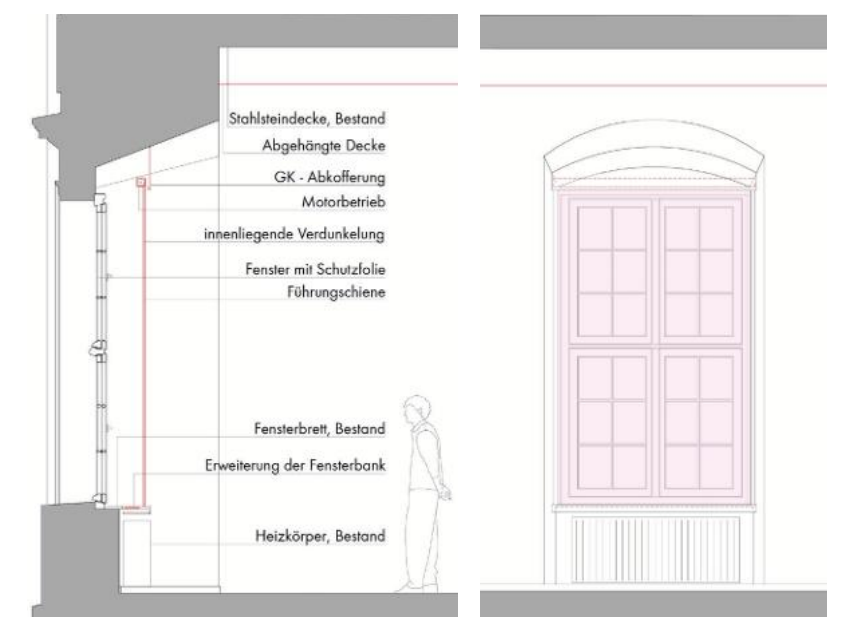
Fensternische - Detail Verdunklung
